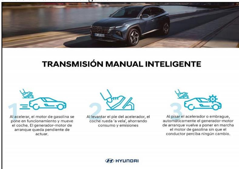
**Nota.** Se representa en la siguiente ilustración el funcionamiento de una caja o una transmisión manual inteligente, así como es la activación de este tipo de transmisión el automotor aplicado a los vehículos HYUNDAI. Fuente. (*Transmisión Manual Inteligente (iMT)*, s. f.).
