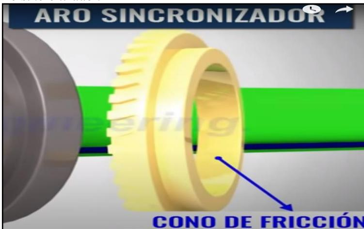
**Nota.** En la siguiente ilustración podemos observar la estructura básica y rápida de cómo es un aro sincronizador de una caja de cambios, así como sus partes. Fuente. (Colombo & Hurd Immigration, 2017).
