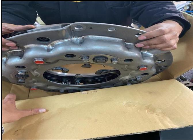
**Nota.** En la siguiente imagen podemos observar la parte exterior del diafragma, como es su estructura de fabricación y los componentes que conforman dicho plato de presión del embrague. Fuente. Autor.
