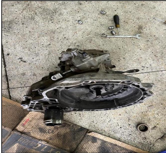
Nota. En la siguiente ilustración podemos apreciar la parte exterior de una caja de cambios manuales, denominada coraza. Fuente. Autor.
