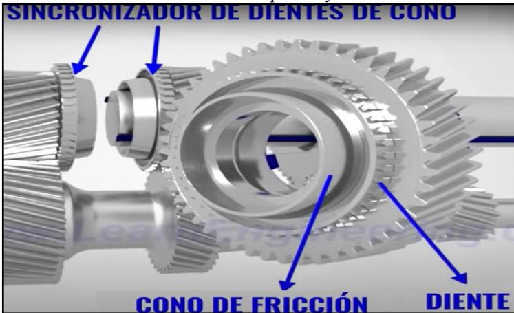
**Nota.** En la siguiente ilustración podremos apreciar y analizar cómo es la estructura de un sincronizador de dientes de cono, así como las partes que cuenta el mismo y como es el acople de este hacia el engrane de marcha. Fuente. (Colombo & Hurd Immigration, 2017).
