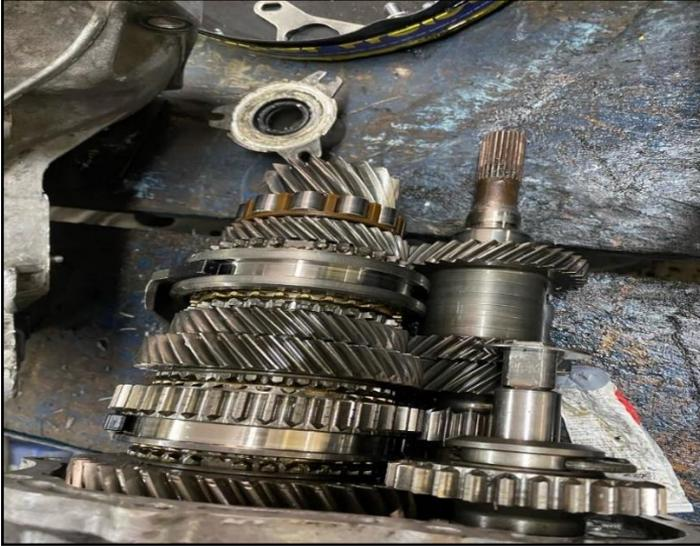
**Nota.** En la siguiente ilustración podemos observar la sincronización de una caja de cambios actual la cual es de engrane constante.
