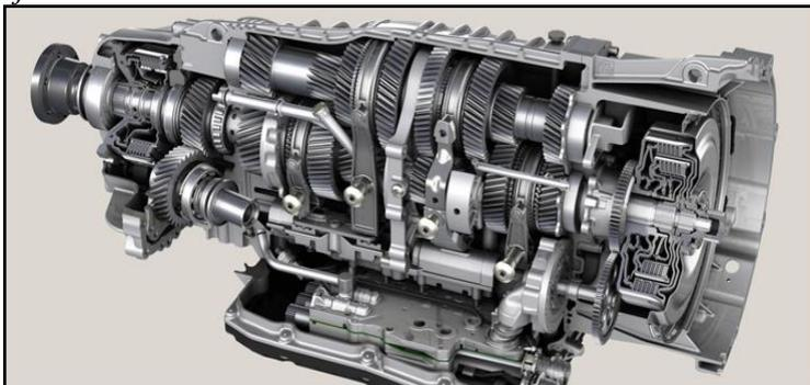
**Nota.** En la siguiente ilustración podemos observar cómo es la forma de una caja de cambios manual, así como está compuesta internamente para el funcionamiento y desarrollo de velocidad de la misma. Nota. (*Funcionamiento de la caja de cambios manual | Blog Autolab, s. f.*). La característica principal de la caja de velocidades o caja de cambios manuales es que el conductor de dicho vehículo es el encargado principal
