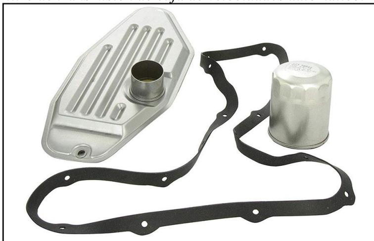
**Nota.** Se representa en la siguiente ilustración el filtro que cuenta la caja de transmisión automática, donde se indica su diseño y su estructura, así como nos da una idea donde va dicho filtro y todos los componentes que lo conforman para su correcto funcionamiento. (*Filtros de Transmisión | Sicar, 2019*).
