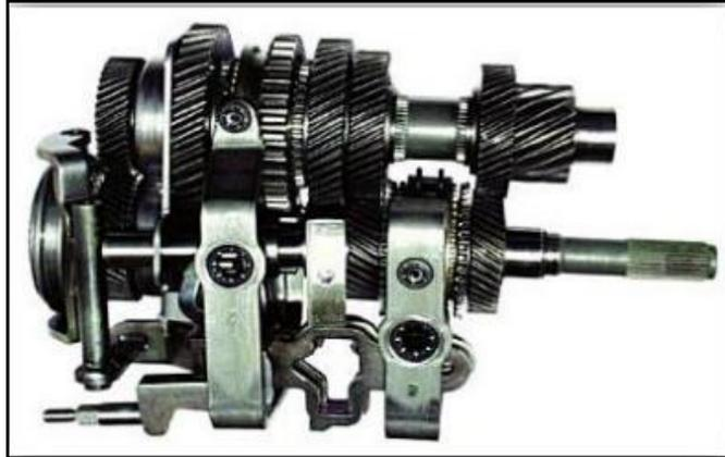
**Nota.** En la siguiente ilustración podemos observar cómo es el acople de las distintas marchas de un vehículo, así como es el diseño de los engranajes de la caja de velocidades. Fuente. (*T-ESPE-058200.pdf*, s. f.).
