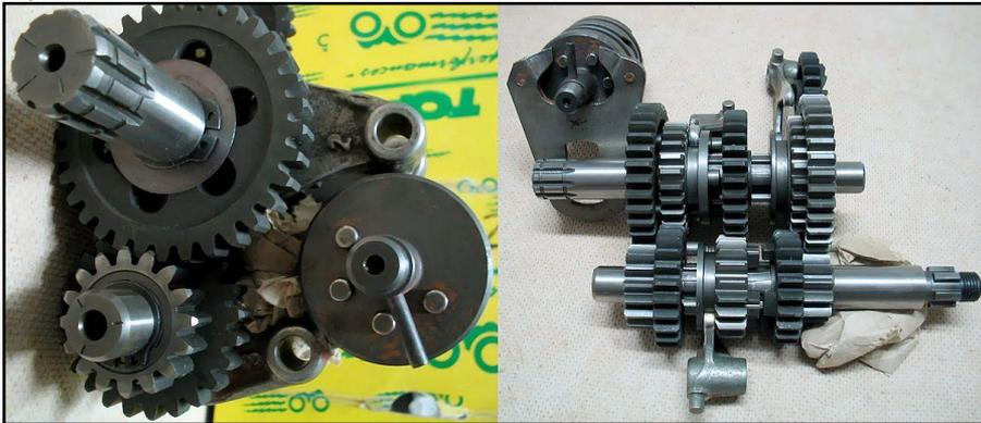
**Nota.** En la siguiente ilustración podemos observar una representación de una caja de velocidades de malla constante. Fuente. («Caja de cambios manual», s. f.).
