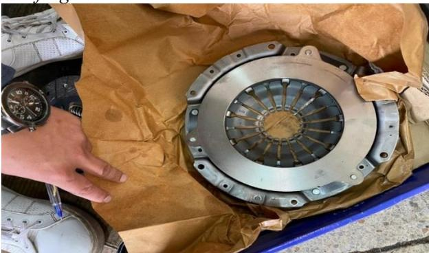
**Nota.** En la siguiente ilustración podemos observar un diafragma del sistema de embrague, podemos analizar sus distintas características y apreciar a simple vista de que materiales podría este fabricado dicho diafragma. Fuente. Autor.
