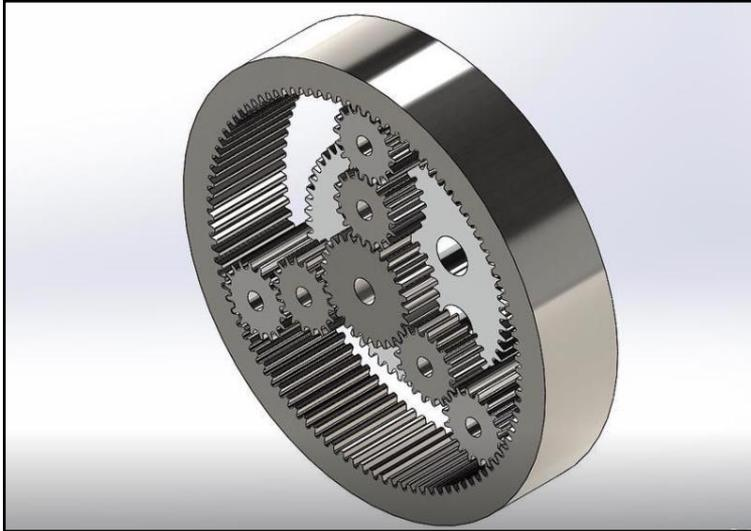
**Nota.** En la siguiente ilustración se puede apreciar el diseño de un engranaje planetario el cual es un mecanismo que funciona en la caja de velocidades automáticas, así como se puede apreciar el diseño con sus múltiples partes con la finalidad de interpretar el funcionamiento de este elemento en la caja de velocidades. Fuente. (AUTOMOTRIZ, 2020).
