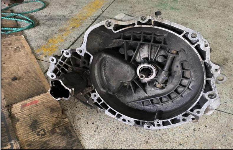
**Nota.** En la siguiente ilustración podemos observar una caja de velocidades y dentro de ella podemos apreciar el ruliman del embrague el cual va a encargarse de generar el movimiento hacia adelante y atrás, acompañando de la horquilla que transmite la presión del pedal del embrague hacia el ruliman. Fuente. Autor.
