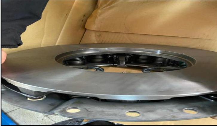
**Nota.** En la siguiente ilustración podemos apreciar los resortes que cuenta en diafragma o el plato de presión, los cuales se van a encarar de presión al embrague para su acoplamiento al volante de inercia. Fuente. Autor.
