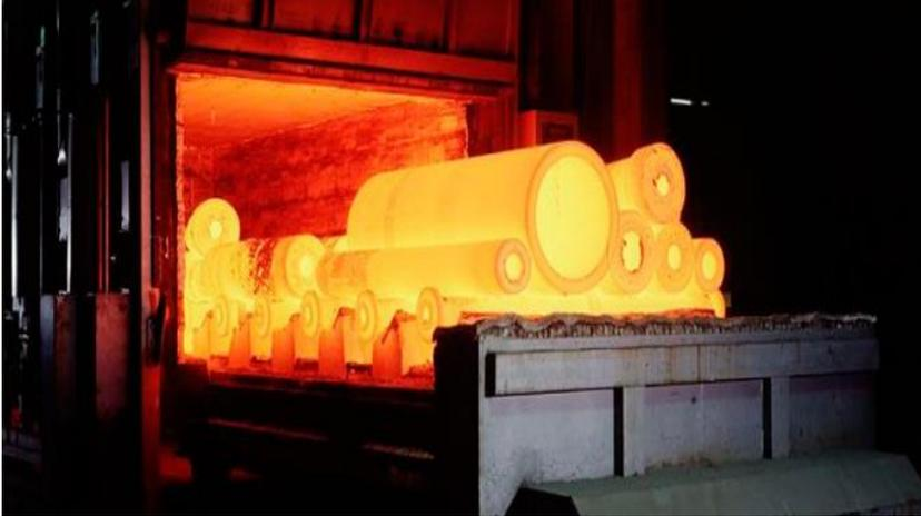
**Nota.** En la siguiente ilustración podemos apreciar cómo es un proceso térmico del recocido en un horno. Fuente. (*Tratamientos Térmicos - Servicios de Fundición de Precisión de Metales | Radver, s. f.*)
