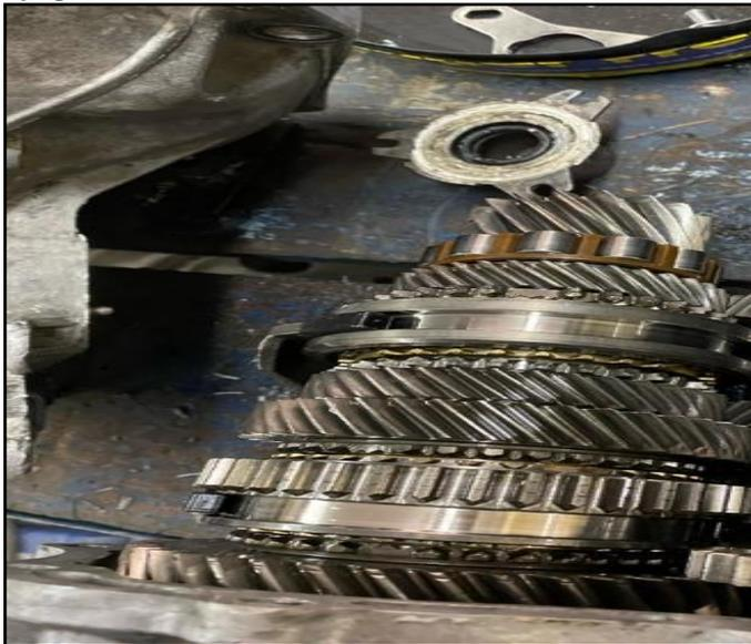
**Nota.** En la siguiente ilustración podemos observar el eje principal o el eje de entrada de una caja de cambios manual de un vehículo Chevrolet Optra. Fuente. Autor.
