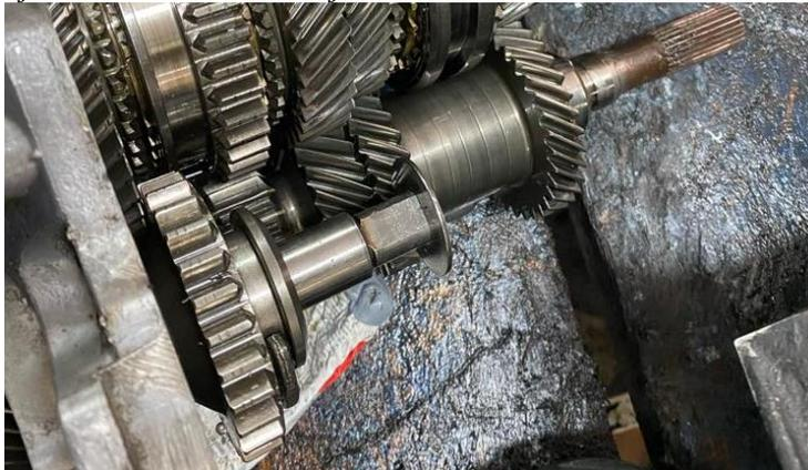
**Nota.** En la siguiente figura podemos observar el eje secundario de una caja de cambios o de velocidades de un vehículo Chevrolet Optra. Fuente. Autor.
