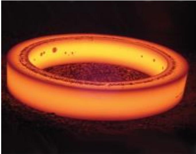
**Nota.** En la siguiente imagen se puede apreciar en lo que consiste un proceso de normalizado en un material para modificar su estructura. Fuente. («Normalizado», s. f.).
