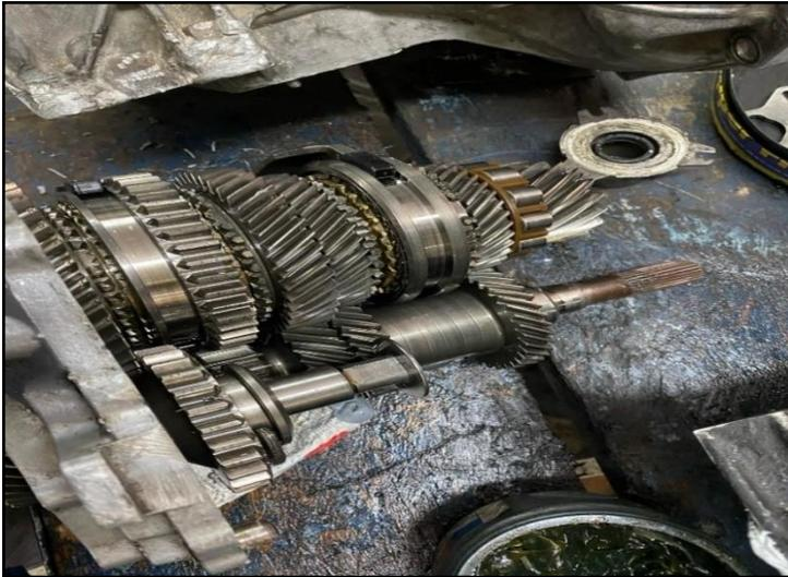
Nota. En la siguiente figura podemos observar una caja de velocidades manuales, como son sus partes internamente y como están conformados todos los sistemas que permiten la transmisión al vehículo. Fuente. Autor.
