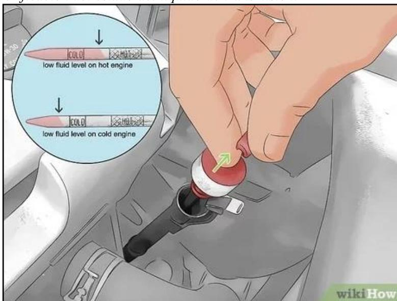
**Nota.** Se representa en la siguiente ilustración una representación de cómo se realiza el chequeo del líquido de transmisión, así como en la imagen hace una representación sobre los estados y los niveles que se debería tener en cuenta para el análisis y el chequeo de dicho sistema. Fuente. (Cómo cambiar el líquido de la transmisión: 10 Pasos, s. f.).
