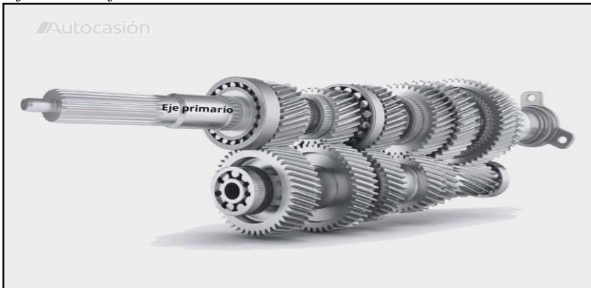
**Nota.** En la siguiente imagen podemos observar los componentes internos de una caja de velocidades, así como los ejes de funcionamiento los cuales permiten el paso de la fuerza generada por el motor hacia las ruedas. Fuente. (*Caja de velocidades*, 2022).
