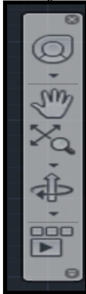
Nota. La barra de navegación cuenta con 5 botones que proporcionan funcionalidades específicas que facilitan la navegación y manipulación de la vista del dibujo según las necesidades del usuario.
