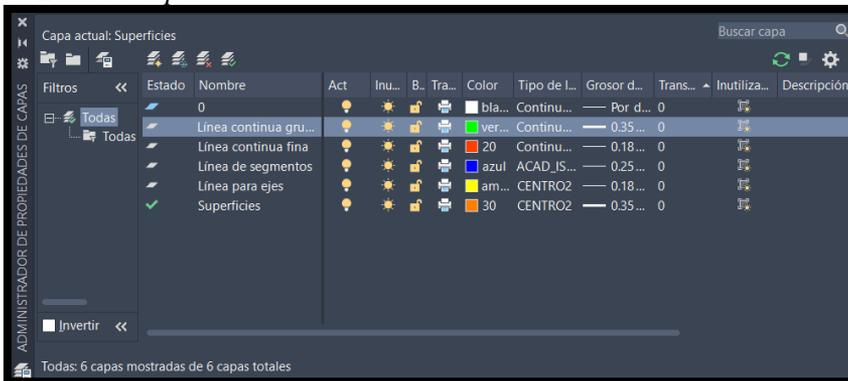
3.- Opciones de trabajo para capas: Antes de iniciar un trazo debemos activar la capa que se ajuste a los parámetros de representación de dicho objeto, para ello el visto sobre la capa, establece la capa designada como la actual. Los objetos creados se dibujan en la capa
