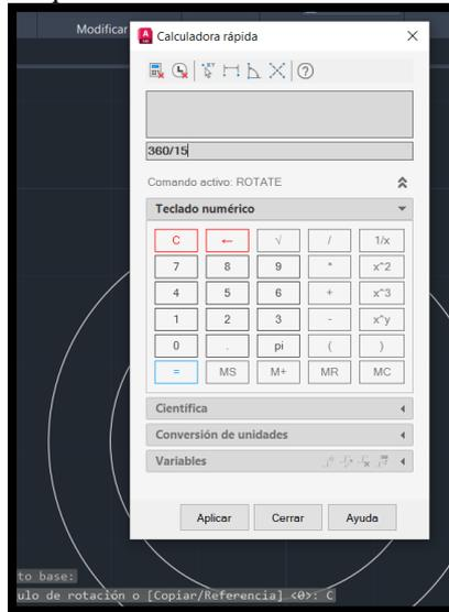
Recortar el nuevo diente y solo conservar la separación entre los mismos, luego aplicar matriz polar y finalizar con el perfil del diente en 2D.
