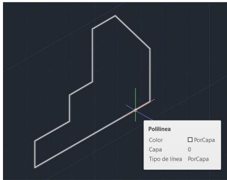
Con la herramienta de EXTRUSIÓN generar el volumen al perfil. Para esto cambiamos a vista ISOMÉTRICA SO y generamos la extrusión.
