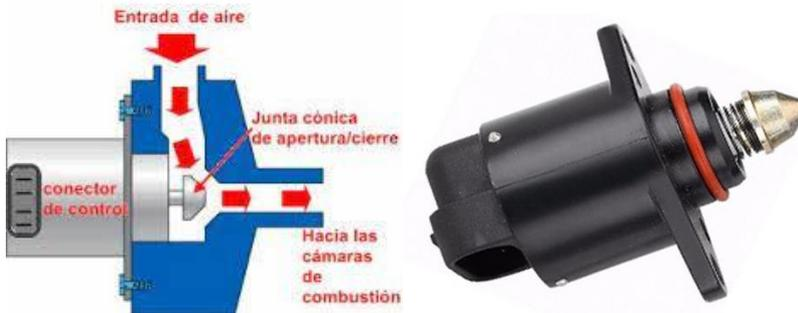
Nota. En la figura se muestra el funcionamiento de la válvula IAC. Fuente. (Admin, 2019)
