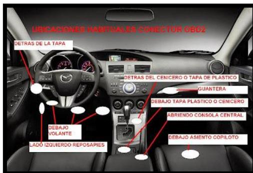
**Nota:** En la figura se observa la ubicación típica del conector obd 2 tomado por los autores. (Teseomotor, 2020)
