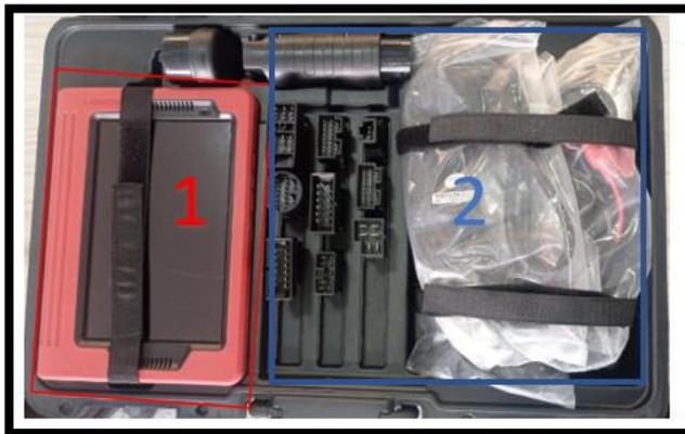
**Nota:** En la figura se observa el maletín del escáner Launch X 431, junto con sus accesorios, tomado por los autores.
