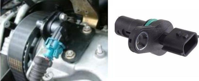
**Nota.** En la figura se muestra la posición que tiene el sensor CMP en el automotor. Fuente. (*Sensor CMP. Qué Es, Ubicación, Funcionamiento, Tipos*, 2023)
