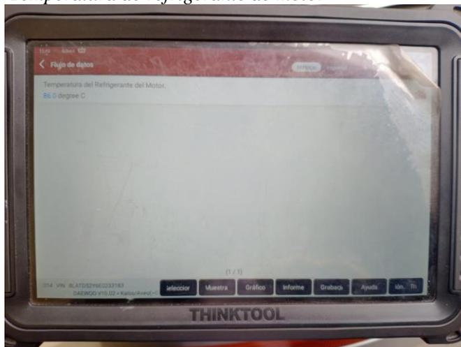
Nota. En la figura se muestra la corrección de temperatura de refrigerante de motor.
