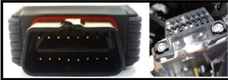
**Nota:** En la figura se observa la ubicación del conector obd 2 en el vehículo Chevrolet Aveo, ubicado en la parte inferior de la columna de dirección, tomado por los autores.
