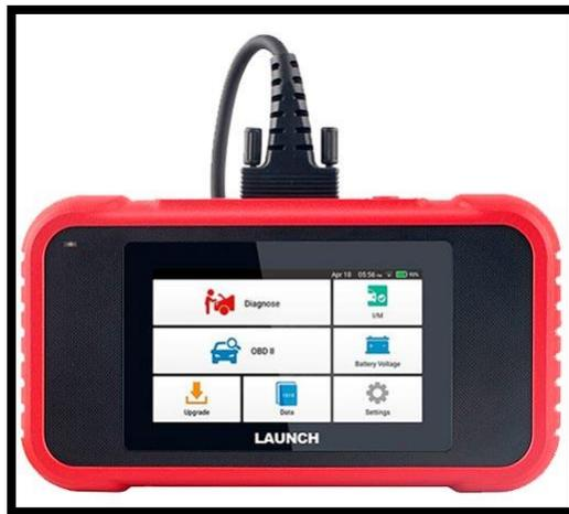
Nota: En la figura se observa un escáner gama media Launch crp123E
