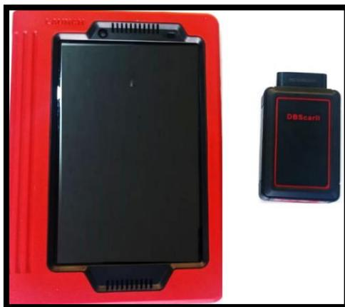
Nota: En la figura se observa el escáner Launch X 431, junto con sus conectores OBD 2 inalámbrico, tomado por los autores.
