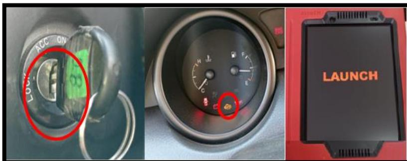
**Nota:** En la figura se observa el proceso de encendido del escáner Launch x 431, tomado por los autores.
