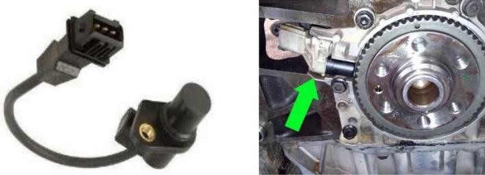
Nota. En la figura se muestra la posición de sensor CKP y la composición de sistema. Fuente:(Sensor de Posición del Cigüeñal CKP Blog Técnico Automotriz - Tienda Online, s. f.)
